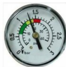
1,3 кг/см 2 : Давление превышает начальное давление более чем на 0,5 \text{ кг/см}^2 , что указывает на необходимость проведения ПРОМЫВКИ.
