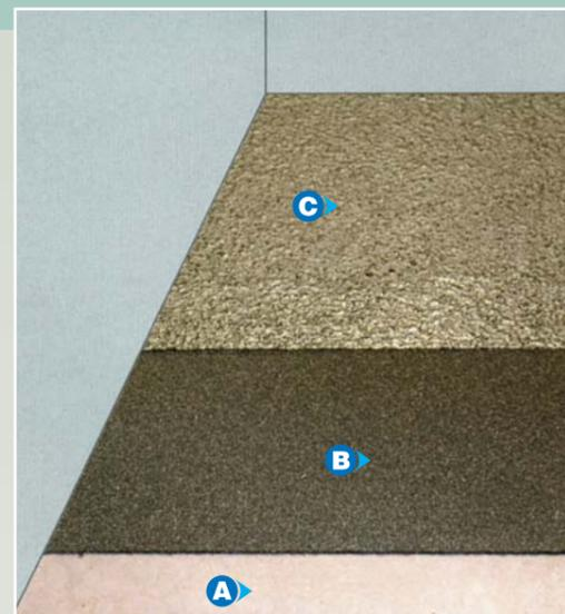
ПАРОПРОНИЦАЕМЫЙ, МАТОВЫЙ ПРОМЫШЛЕННЫЙ ПОЛ НА ОСНОВЕ ВОДНОЙ ДИСПЕРСИИ ЭПОКСИДНОЙ СМОЛЫ, БЕЗ РАСТВОРИТЕЛЕЙ, СРЕДНЯЯ ТОЛЩИНА 3 мм, НЕСКОЛЬЗЯЩАЯ ПОВЕРХНОСТЬ.
